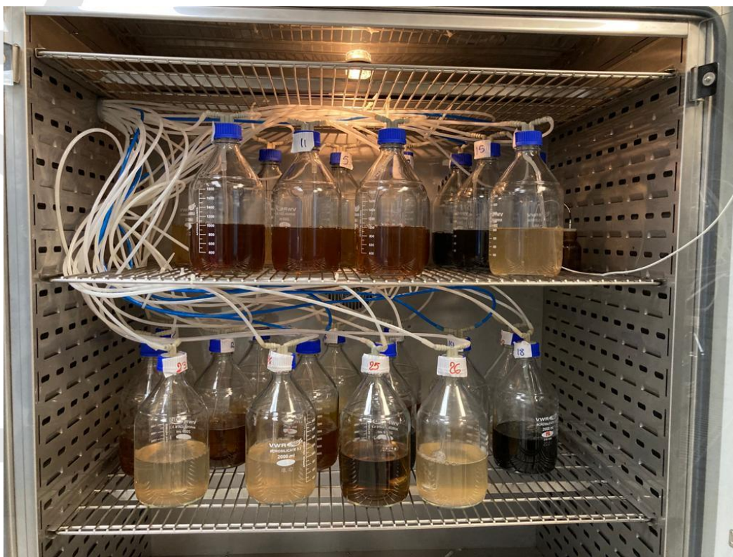
Figura 4. Immagine del set-up del test di biodegradabilità
